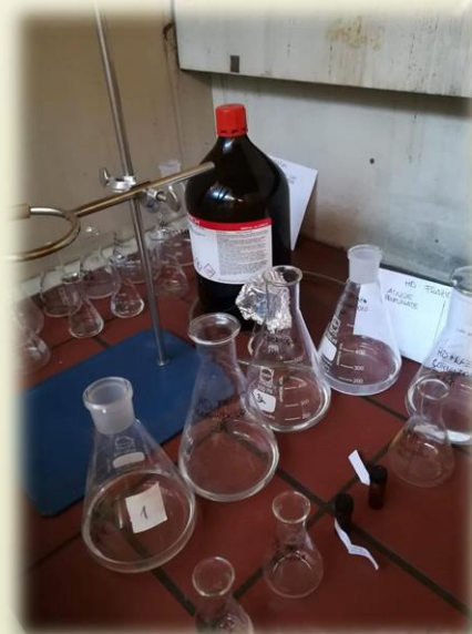
ANIDRIFICAZIONE CON SOLFATO DI SODIO ANIDRO
