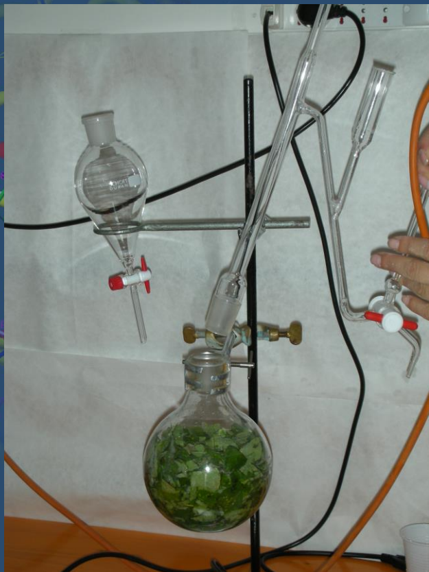
Fase di montaggio dell'apparecchio di distillazione in corrente di vapore
