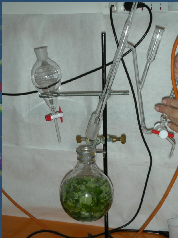
Fase di montaggio del distillatore
